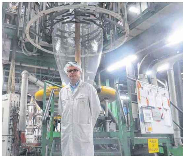
Ceisa Packaging a réalisé des investissements pour adapter ses lignes de production à son nouveau projet. Pour fabriquer le film R100, la matière vierge est remplacée par la matière recyclée. Pour aboutir au film plastique final imprimé (en bas à droite), les granulés issus de la broyeuse (en haut à droite), après avoir été refroidis et stockés dans des sacs énormes, vont alimenter les extrudeuses avec le phénomène de formation d'une bulle (en bas à gauche).
