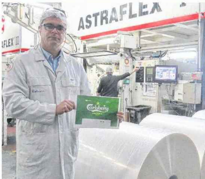
Ceisa Packaging a réalisé des investissements pour adapter ses lignes de production à son nouveau projet. Pour fabriquer le film R100, la matière vierge est remplacée par la matière recyclée. Pour aboutir au film plastique final imprimé (en bas à droite), les granulés issus de la broyeuse (en haut à droite), après avoir été refroidis et stockés dans des sacs énormes, vont alimenter les extrudeuses avec le phénomène de formation d'une bulle (en bas à gauche).
